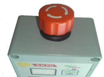
Rys. 3. Widok sterownika od góry, wyłącznik bezpieczeństwa należy włączać przekręcając go zgodnie z ruchem wskazówek zegara. Wyłączenie polega na wciśnięciu wyłącznika.
