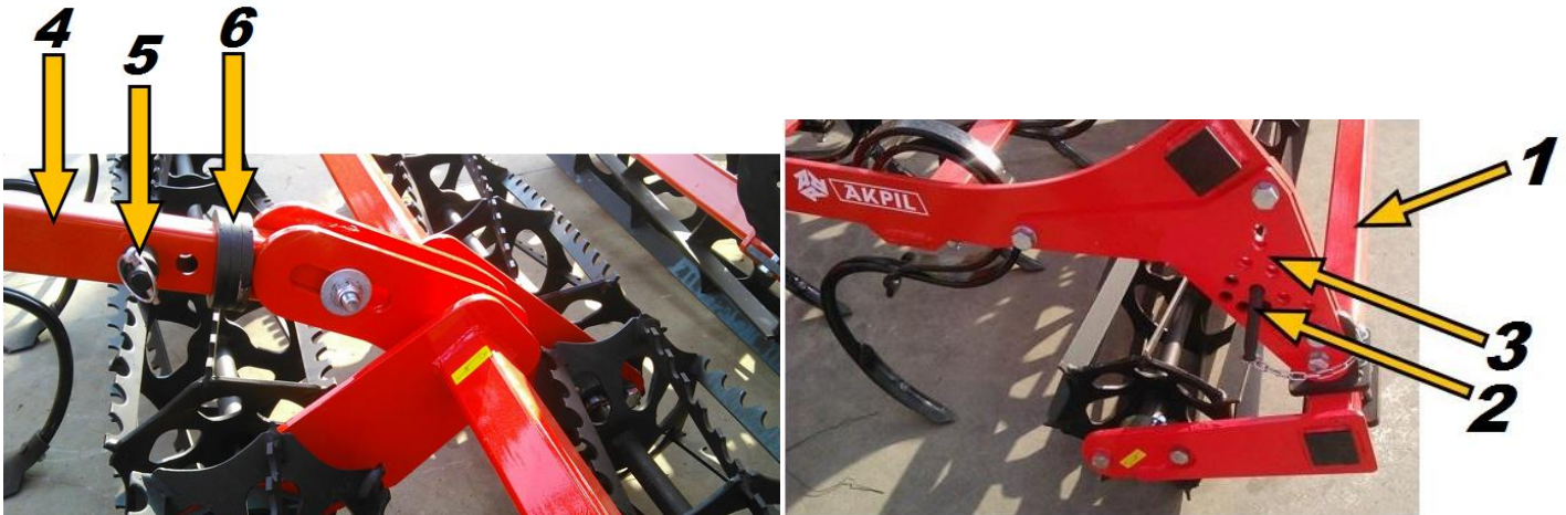
Rysunek 9. Regulacja agregatu. 1 – Zespół wałów przednich, 2 – Przetyczka, 3 – Regulator, 4 – Łącznik, 5 – Przetyczka, 6 – Podkładka regulacyjna.
