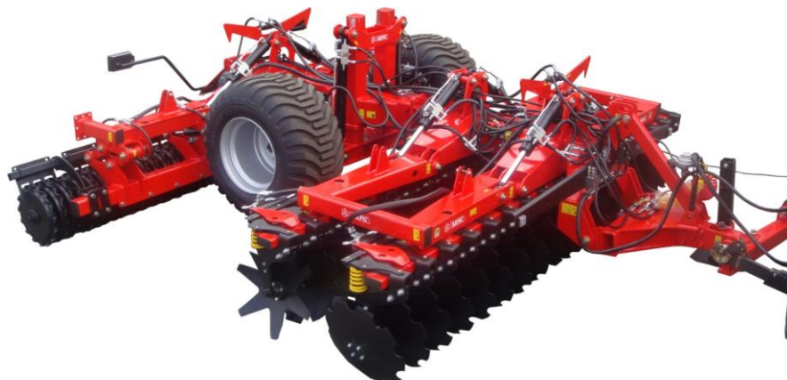
Rys. 12 Agregat TIGRE XL koła przed wałem doprawiającym(jedna z opcji konfiguracji).
