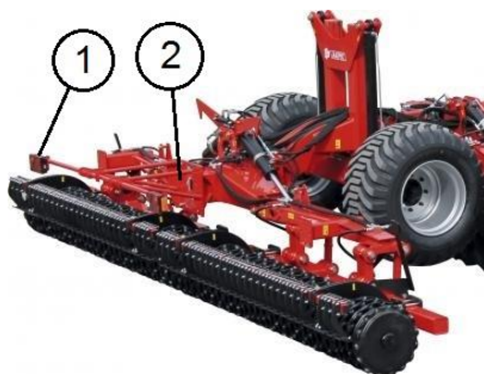
Rys. 26 Oznaczenie świetlnego-sygnalizacyjne: 1- Miejsce mocowanie tablicy ostrzegawczej. 2- Miejsce mocowania oświetlenia i oznaczenia ograniczenia prędkości.
